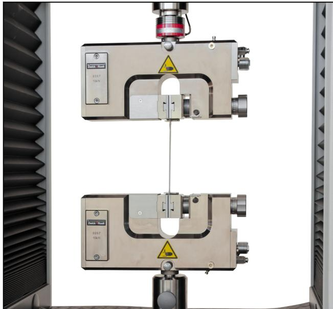
Pneumatik-Probenhalter Typ 8397, Fmax 10 kN
