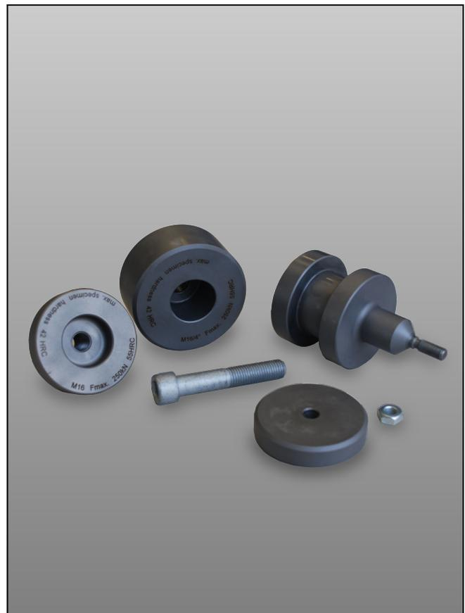
Probenaufnahmen 600 kN
