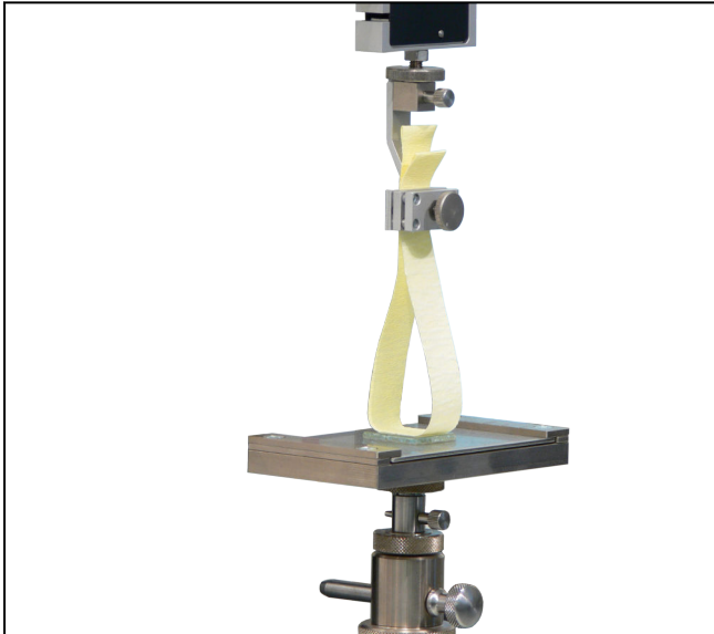
Schraub-Probenhalter Typ 8153; Fmax 20 N
